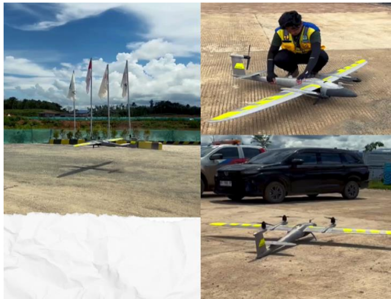
Gambar 5. Drone VTOL UAV Untuk Survei (Source: Pusdatin PUPR, 2024)
